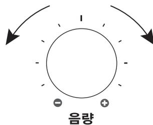
우측 패널의 전원 버튼 아래에 위치한 주음량(Volume) 조절 노브를 이용하여 적당한 음량으로 설정합니다. (주음량 조절 노브를 왼쪽으로 돌리면 소리가 작아지고, 오른쪽으로 돌리면 음량이 커집니다)
